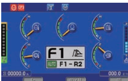
Modo automático de transmissão de modo a reduzir o consumo de combustível
