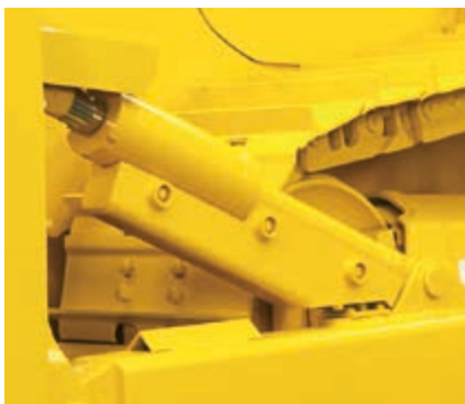
As linhas hidráulicas estão embutidas nas estruturas sempre que possível
