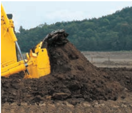
A lâmina Sigmadozer® oferece maior capacidade de manter o material
